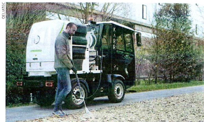
Le porte-outil électrique Mollen nouvelle génération d'Oeliatec, élaboré avec l'entreprise bretonne Karr, porte ici une unité de désherbage Houat Skid.
