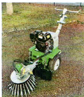
Fort du succès de sa cellule à brosse GK-H, Cornu va renforcer la conception pour en faire un porte-outil hydrostatique plus polyvalent.
