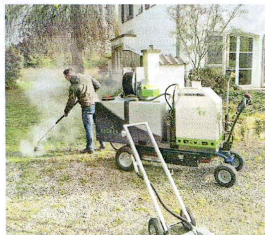
Le Komex Jespi 12 V de Keckex, marque distribuée par MME Environnement, est un désherbeur compact combinant les avantages de l'eau chaude et de la vapeur.
