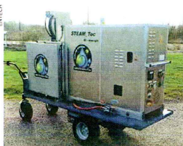
Le Steam-Tec biénergie d'Entech monté sur chariot électrique.
