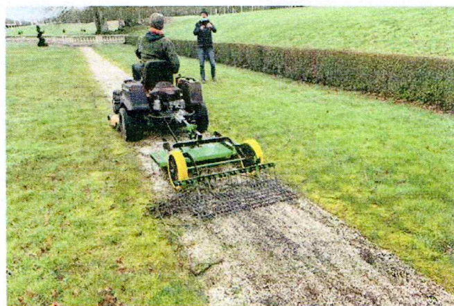
Les machines compactes et légères comme ce désherbeur mécanique d'Avril Industrie (modèle 100L) peuvent séduire parfois autant que de gros engins difficiles à transporter.
