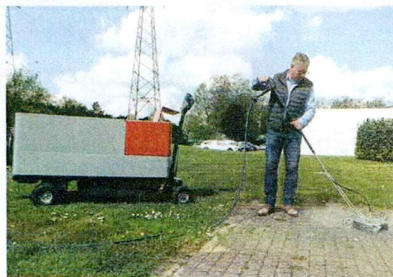
Module de désherbage à eau chaude Weco S GO de Weed Concept, posé sur chariot électrique.
