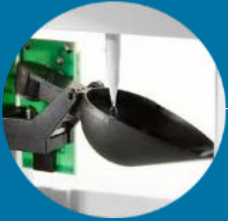
CUILLÈRE À SIMPLE AUGET BASCULANT Mesure précise de la pluviométrie ( \pm 0,2 mm)
