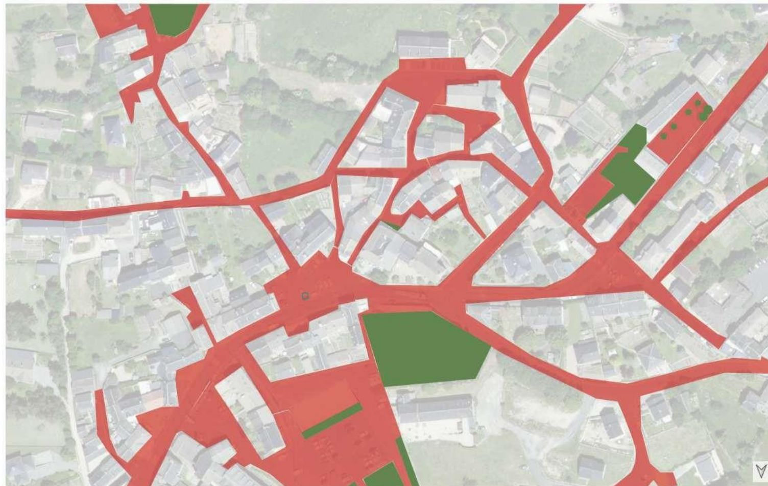
Qualification des espaces publics : en vert, enherbement dominant - en rouge, revêtement imperméable (enrobé)
