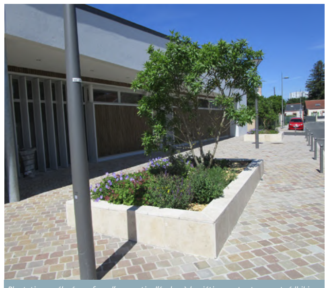
Plantation surélevée en face d'une sortie d'école où le piétinement est souvent rédhibitoire pour le développement des végétaux./ Pierre Héry
