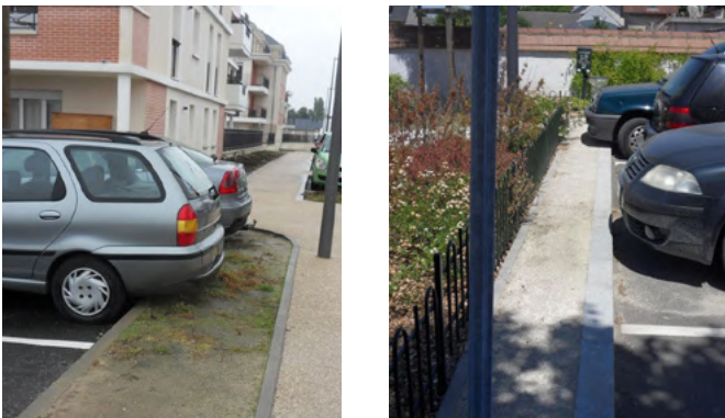
Quel avenir pour les végétaux qui doivent être plantés sur cette bande empiétée par les véhicules en stationnement ? La bande passe-pied permet d'éviter ce problème./ Pierre Héry
